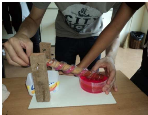
Parafuso de Arquimedes, construído pelos alunos
